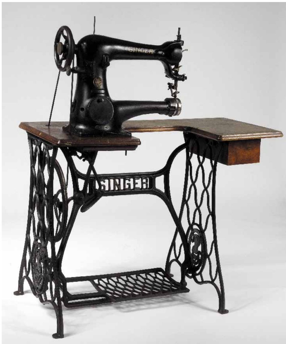
Maszyna szewska, łaciarka, do reperacji obuwia firmy Singer, lata 30. XX w., warsztat szewski Wiktora Malcharka.
